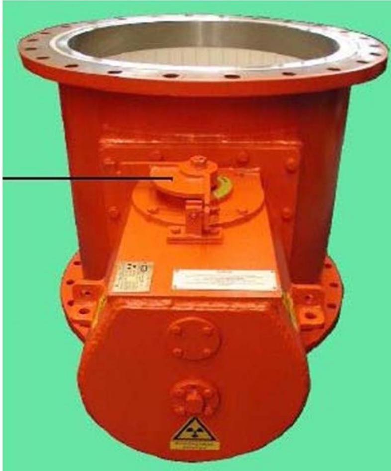
Palanca del obturador en la posición cerrada.
