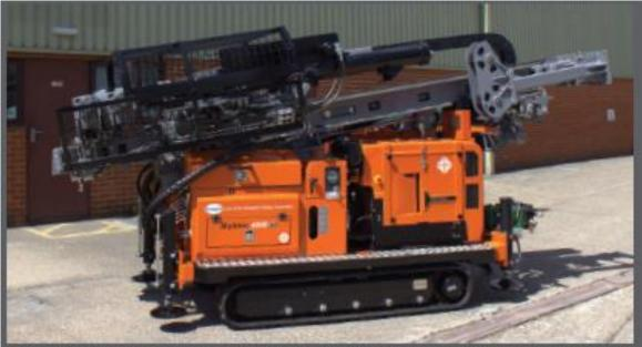
Compacto y ligero montado sobre orugas, ideal para maniobrar a través de áreas estrechas de difícil acceso. La sonda también está disponible con una opción de orugas extensibles que permiten las orugas extenderse hasta 2m de ancho. Esta sonda de perforación entra dentro de un contenedor estándar de 20ft para transportarlo fácilmente.
