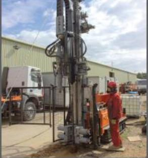
Cabezal giratorio de 4 velocidades montado con Sistema opcional Dando 3D diseñado para la movimiento lateral hidráulico y con opción de toma de muestras sin perturbar y también para cabezal flotante.
