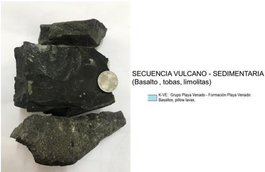
Figura 6. Litología representativa del sitio de presa Guararé y su correlación con la unidad geológica presente según el mapa geológico de Ministerio de Comercio en Industria (1991)
