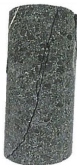
Muestra a 14.4 m Resistencia muy baja AZ-GU-BH-02
