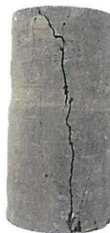
Muestra a 17.3 m Resistencia baja AZ-GU-BH-01
