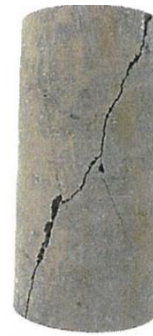
Muestra a 14.3 m Resistencia media AZ-GU-BH-01
