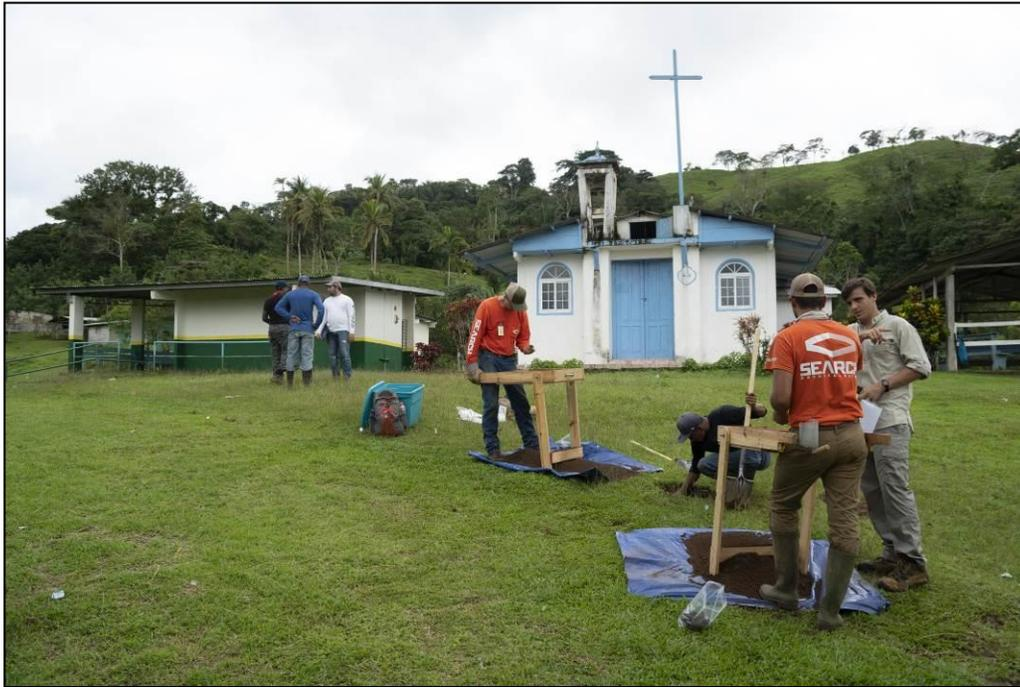
Figura 18. Excavación del pozo de prueba 12 frente a la iglesia de Uracillo.
