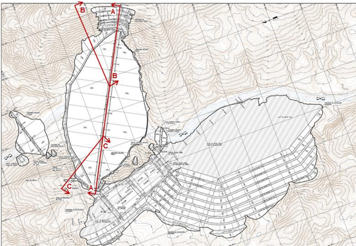
Figura 39. Ubicación en planta, secciones analizadas en Slide.
