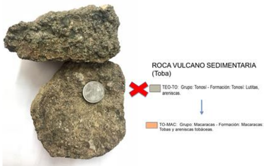
Fotografía 2. Toba representativa del sitio de presa El Gato y su correlación con la unidad geológica presente según el mapa geológico de Milton J. Solano, 1990.
