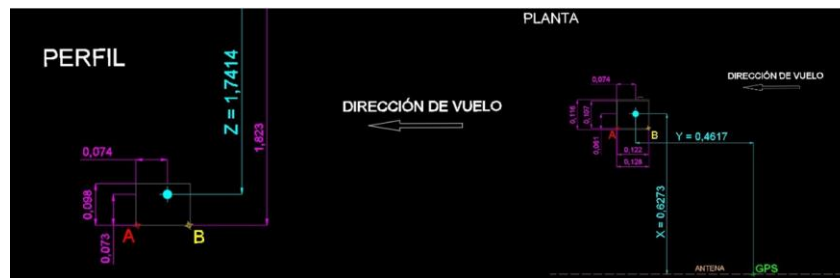
Figura 7. Medida desplazamiento IMU – Antena GNSS Fuente: elaboración propia del autor
