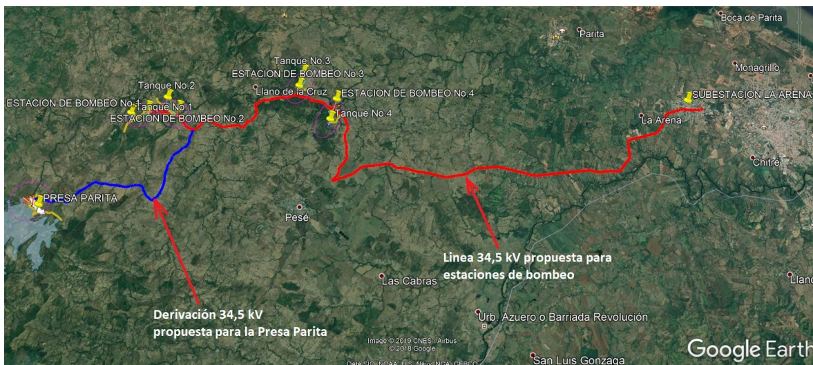
Figura 3. Conexión Presa Parita con la línea que alimenta las estaciones de bombeo sobre el río Parita Fuente: Elaboración propia, a partir de Google Earth
