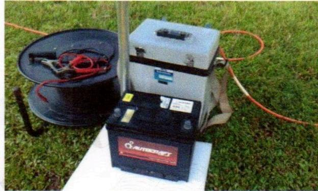
Figura 5 Resistivímetro Syscal R1 – switch 48 de IRIS Instruments y accesorios empleados en este estudio.
