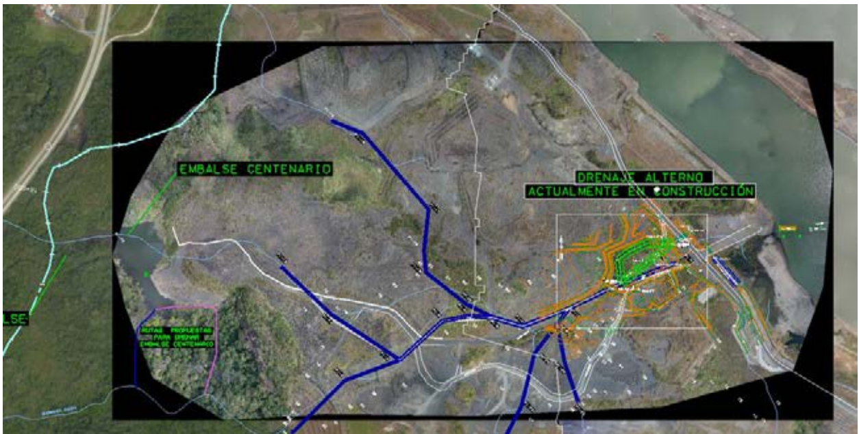
Figura No. 30. Red de drenajes subterráneos creados y localización del drenaje excavado.
