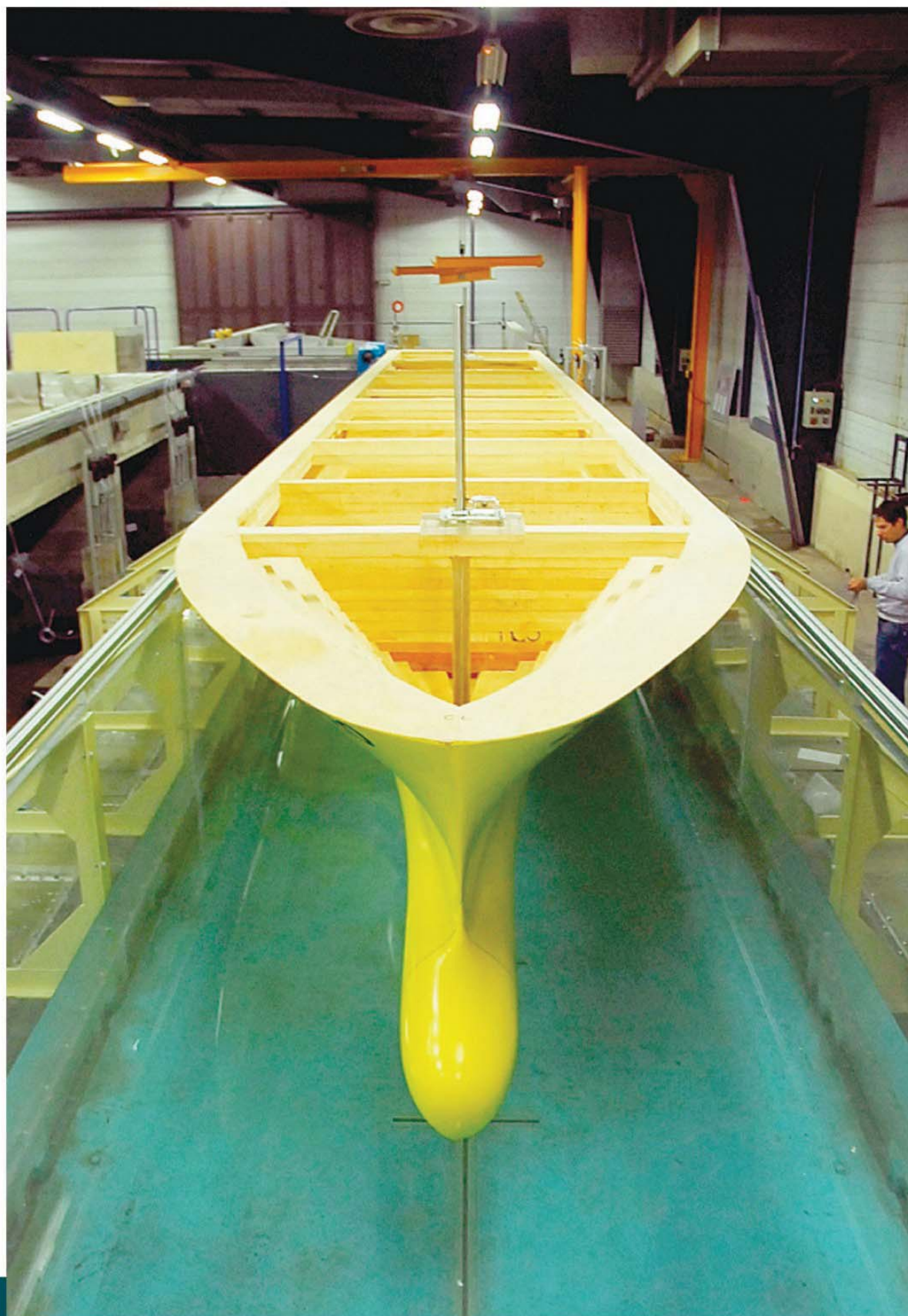
Este buque postpanamax a escala es probado en el modelo hidráulico del sistema de llenado y vaciado del tercer juego de esclusas que se construyó en Lyon, Francia.
