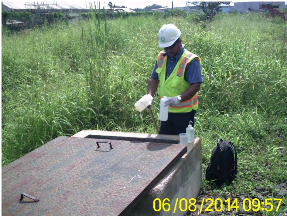
Toma de Muestra de Agua de Planta de Tratamiento de Aguas Residuales No.8 WWTP8 Detrás del Almacén
