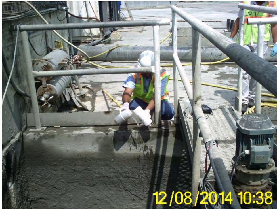
**Toma de muestra de agua de Betonwash**
