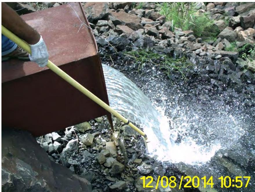
**Toma de muestra de agua residual en Sitio de Disposición 2 Caja 2**
