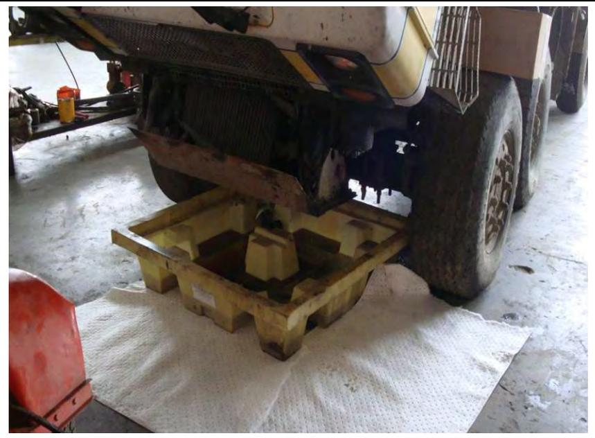
8. Buen uso de bandejas de goteo y almohadillas absorbents en los talleres Esclusas del Pacífico / Good use of drip trays and sorbent pads at the Pacific Locks work shops
