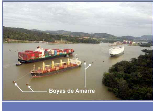
Figura A-19 La zona de amarre en el Lago Miraflores contribuye a mejorar la capacidad del Canal al maximizar el uso de las esclusas del Pacífico durante los cambios de dirección de los convoyos rumbo al norte y rumbo al sur.
