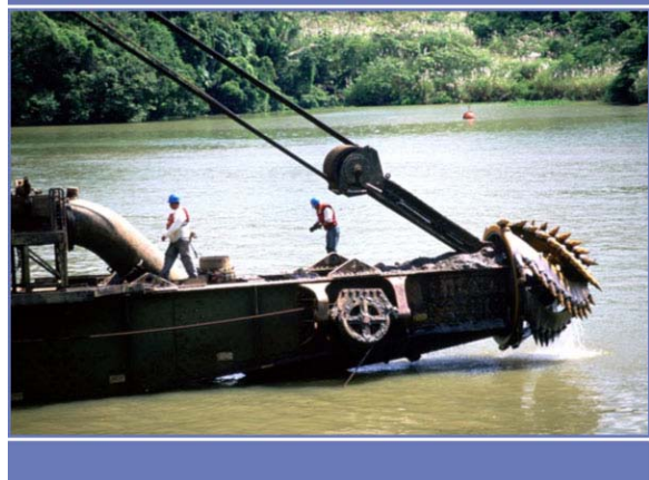
Figura A-35 La Draga de corte-succión Mindi se utiliza para el dragado de material suave.
