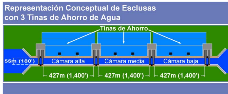
Figura 6-20 Representación artística de la esclusa pospanamax de tres niveles, con doble juego de compuertas rodantes y tinas de reutilización de
