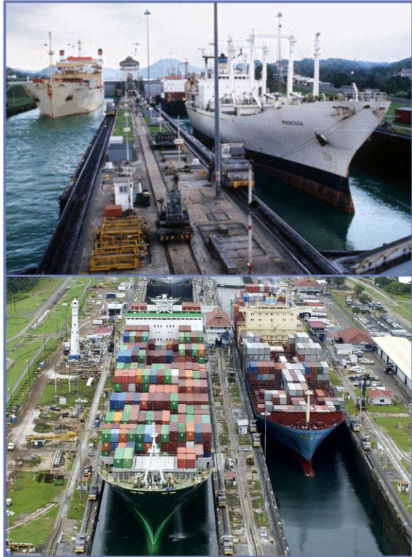
Figura 4-9 Los buques refrigerados, menos de 27.7 metros (91') de manga, transitan por el Canal con pocas restricciones. Los buques porta contenedores con más de 30 metros (100') de manga, Panamax, (abajo) transitan por el Canal con numerosas restricciones.
