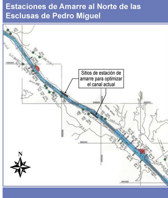
Figura 5-12 Para maximizar la utilización de las esclusas del Pacífico, especialmente en el caso de la esclusa de Pedro Miguel, se requerirá de nuevas estaciones de amarre en el extremo sur del Corte Culebra.
