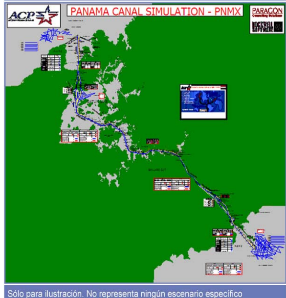
Figura 2-5 Mediante la simulación de los tiempos de navegación y esclusaje y de las reglas y restricciones operativas el modelo de simulación de capacidad del Canal permite evaluar el nivel de servicio que recibirán los clientes del Canal bajo distintos escenarios.
