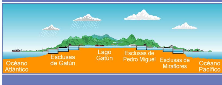
Figura 5-1 Las esclusas del Canal en Gatún, Pedro Miguel y Miraflores definen los límites de tamaño y cantidad de buques que pueden transitar por el Canal.
