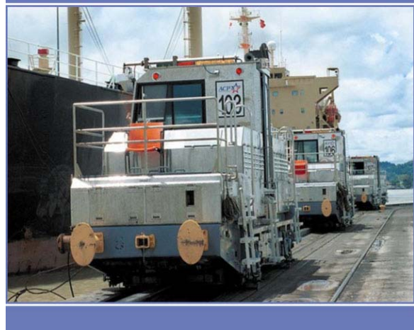
Figura A–23 El Canal cuenta con una flota de 100 locomotoras para el posicionamiento de buques en las cámaras de las esclusas.
