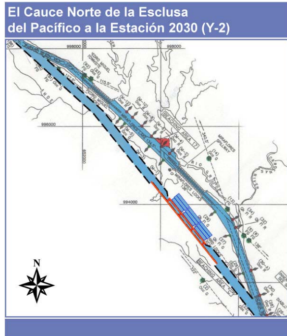
Figura 6-31 Cauces de navegación del Canal ampliado al norte de la esclusa pospanamax del Pacífico estarían restringidos a una vía para buques pospanamax
