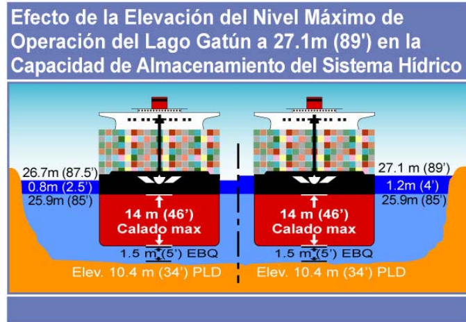
Figura 7-32 El proyecto de subir el nivel máximo de operación del lago Gatún a 27.1m (89') permitiría aumentar el espacio de almacenamiento de lago Gatún de 0.8 m a 1.2 m.
