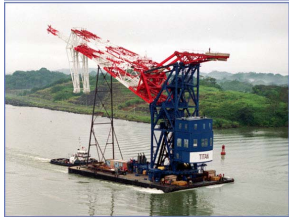
Figura A-36 La grúa flotante Titán se utiliza durante la instalación o desinstalación de compuertas en las esclusas.
