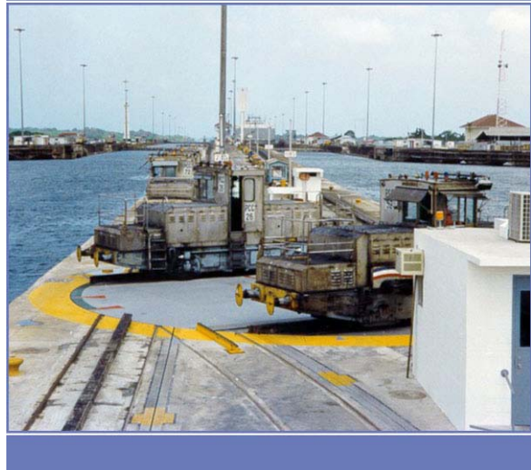
Figura 5-14 Las tornamesas existente en las esclusas de Gatún deberán ser actualizadas para operar en forma continua durante operaciones en modo de carrusel.
