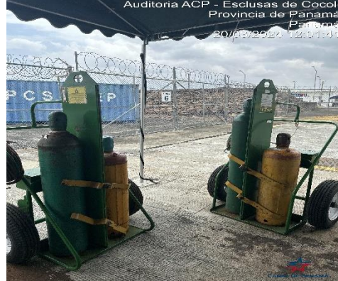
Gases comprimidos en taller ubicados dentro de canasta y asegurados.
