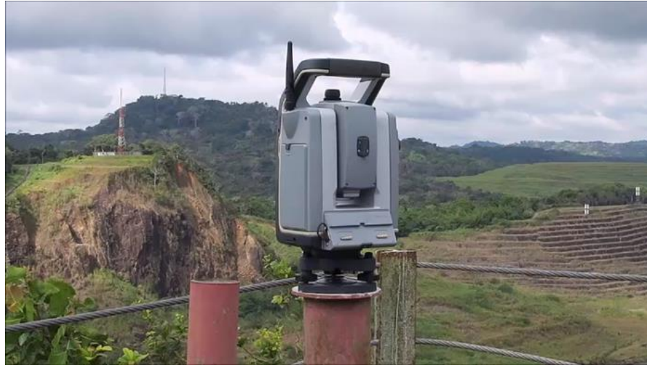
Instrumentación superficial Estación robótica, Cerro Escobar
