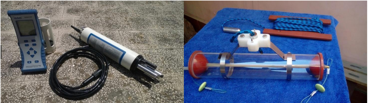
Figura 1. Equipo de Calidad de Agua Hydrolab DS5 y botella para colecta de muestras de agua.
