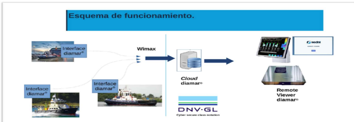
Anexo1. Esquema de sistema de Monitoreo Remoto de Remolcadores Propuesto.
