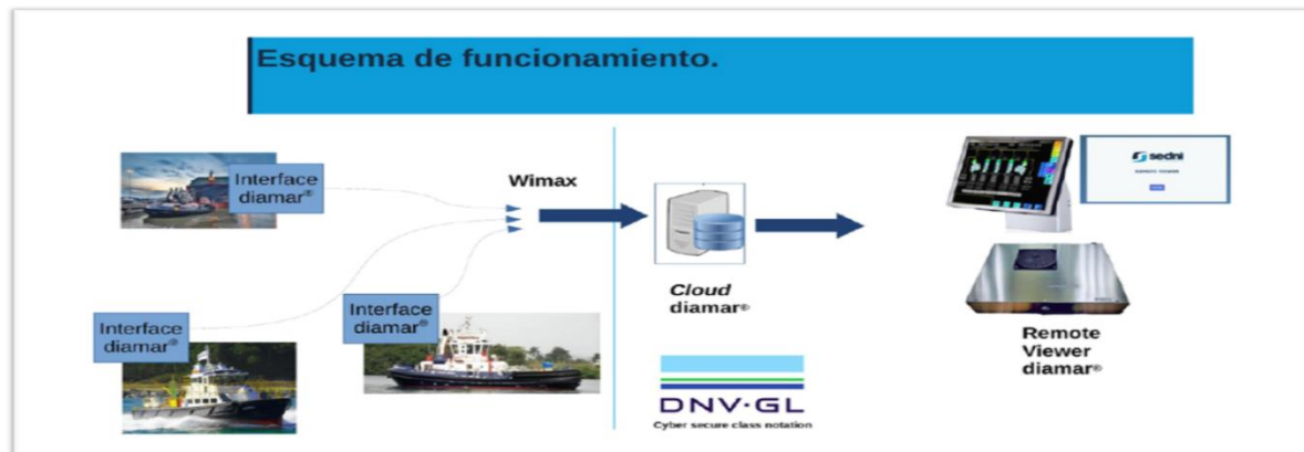
FIGURA 4.8 ESQUEMA DE SISTEMA DE MONITOREO REMOTO DE REMOLCADORES PROPUESTO.
