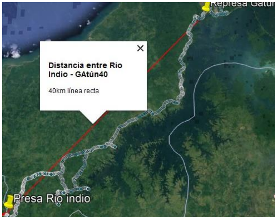
Figura 8. Conexión con la subestación cercana a la CH Gatún a 6,9 kV
