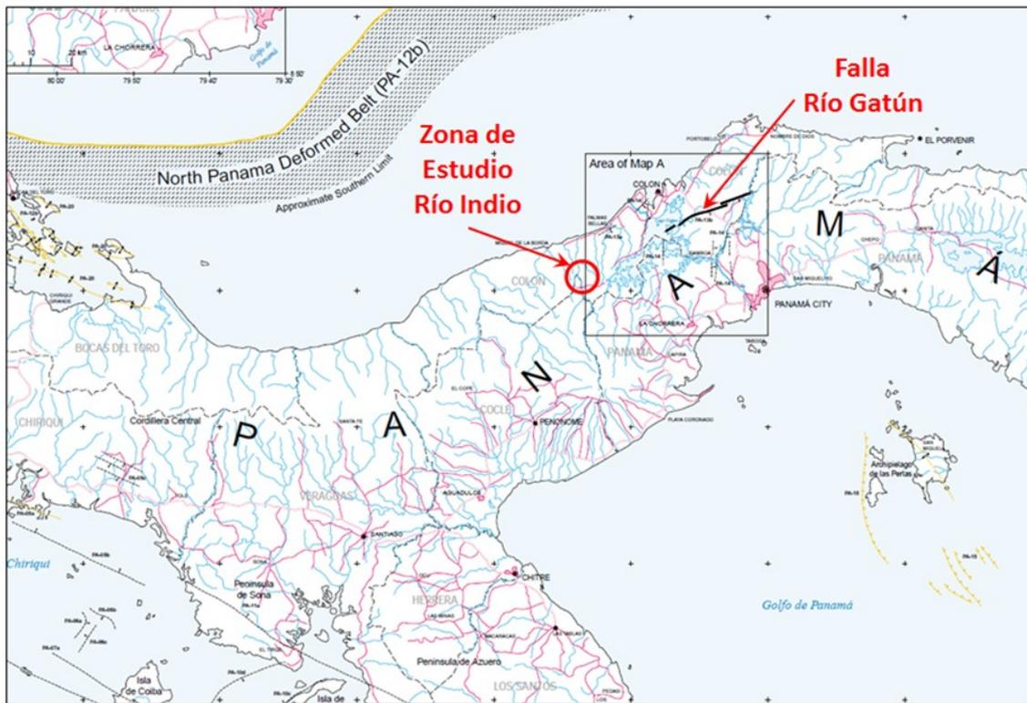
Figura 42. Mapa de Fallas Cuaternarias de Panamá con localización del reservorio propuesto del Río Indio al Suroeste de la traza de la Falla del Río Gatún. Tomado de Cowan et al (1998)
