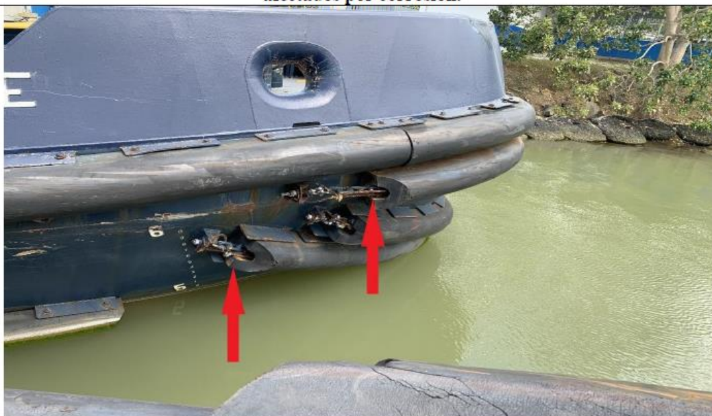
Figura N°40. Cadenas, láminas y elementos de sujeción de las defensas en popa/babor, averiados y afectados por corrosión.
