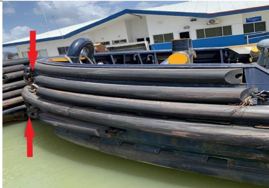
Figura N°39. Cadenas, láminas y elementos de sujeción de las defensas en proa/babor, averiados y afectados por corrosión.
