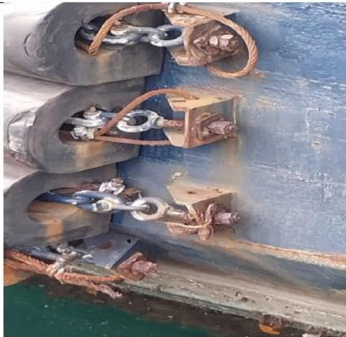
Figura N°33. Cadenas, láminas y elementos de sujeción de los defensas afectados por corrosión, en proa y popa de los lados de babor y estribor presentan esta condición.
