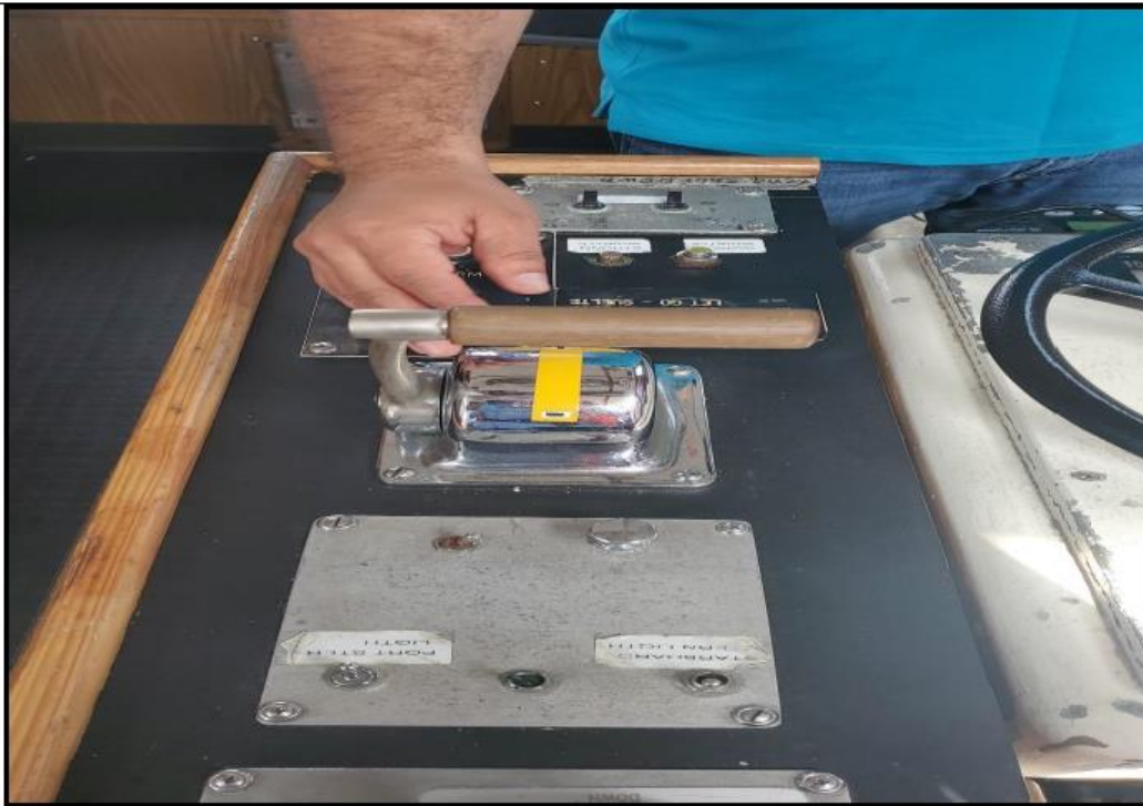
Figura N°25. Control de gobierno de máquinas principales (Operativo).
