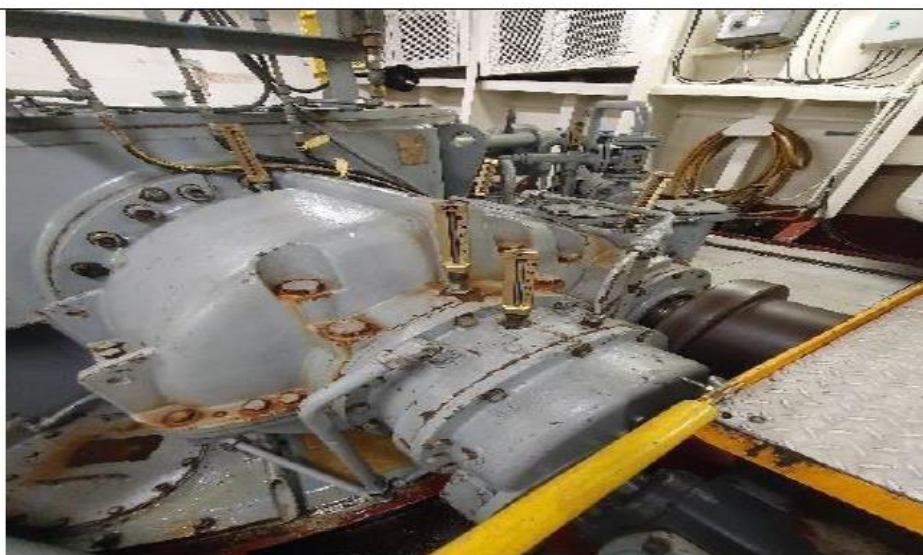
Figura N°7. Convertidor de torque de estribor (Operativo).
