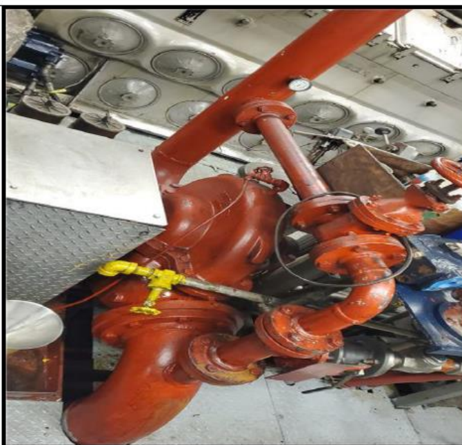
Figura N°14. Bomba FIFI (Operativo).
