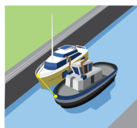
2 El barco posicionándose en el costado de la cámara amarrado al remolcador.
