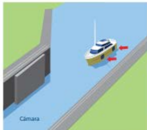
1 Barco ingresando a la cámara, con sus respectivas defensas colocadas.
