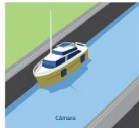
2 Entra a la cámara y se posiciona en el costado del muro.
