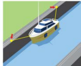
3 Es amarrado con dos sogas (1 en proa y una en popa) y las dos de repuesto en cubierta.
