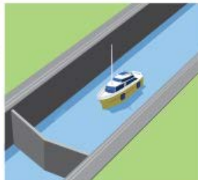
2 Entra a la cámara y se posiciona en el medio para ser amarrado.
