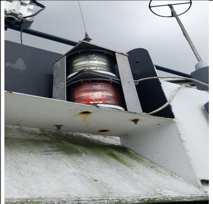
Figura N°28. Luces de navegación babor/estribor (Operativo).
