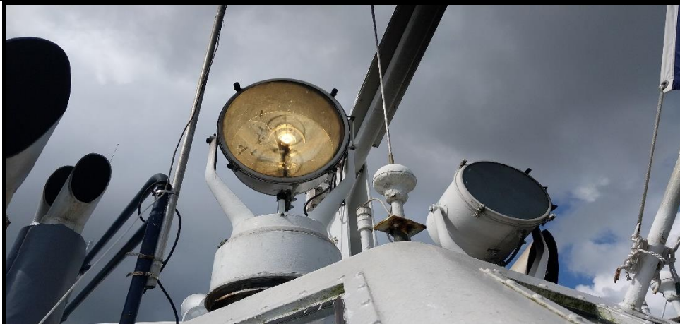
Figura N°27. Luces de búsqueda y mecanismos de movimientos (Operativo).
