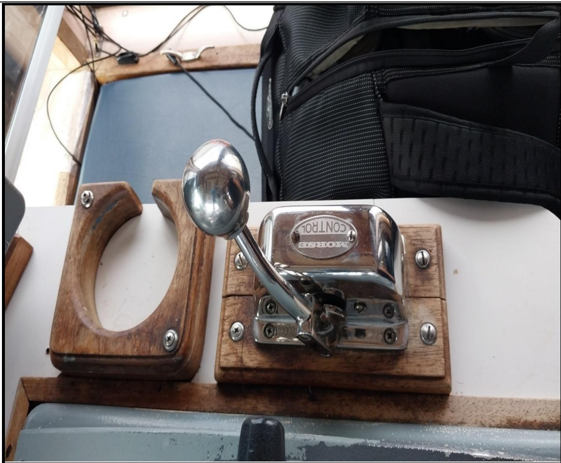
Figura N°24. Control de gobierno de máquinas principales (Operativo).
