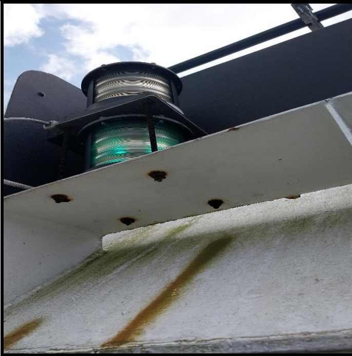
Figura N°28. Luces de navegación babor/estribor (Operativo).
