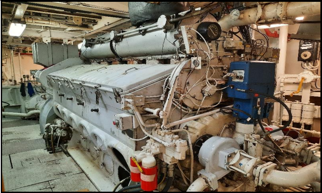
Figura N°3. Máquina principal de estribor (Fuera de servicio).
